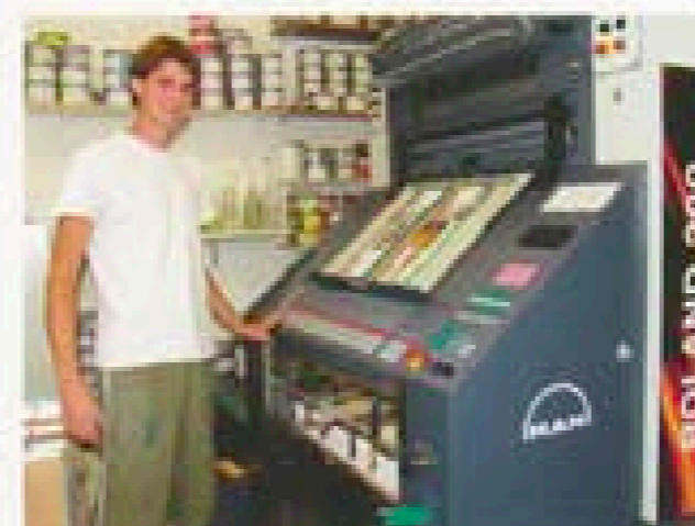
Drucker Stefan Kruckenberg am integrierten Auslegerbedienpult und beim Plattenwechseln. Die Automatisierung EPL (Ergonomic Plate Loading) ermöglicht den Wechseltvorgang innerhalb einer Minute je Druckwerk.
